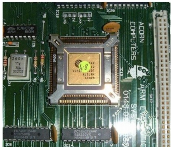
Foto del primo processore ARM, denominato "ARM1"
